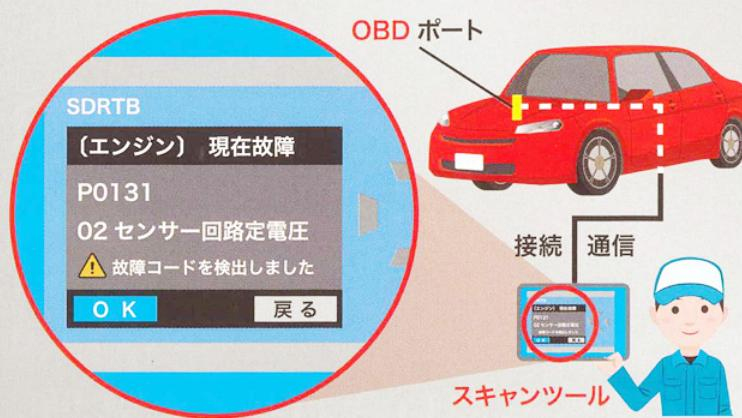
「スキャンツール」をOBDポートに接続し、「OBD」が記録している、各種装置の故障の有無や作動状況（故障コード）を読み出します。これにより、装置が正常に作動しているかを確認することを、「OBD点検」と呼びています。
